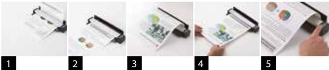
**1** Das Blatt mit der Vorderseite nach oben gewandt einlegen und die Scan-Taste drücken **2** Der iX100 scannt die Vorderseite. **3** Die Seite wird mit der Vorderseite nach unten ausgegeben (bei Einstellung der U-förmigen Papierführung). **4** Das Blatt erneut zuführen, ohne die Scan-Taste zu drücken. **5** Die Rückseite wird gescannt. Die Scan-Taste zur Beendigung des Scanvorgangs und Erzeugung einer PDF-Bilddatei drücken.
